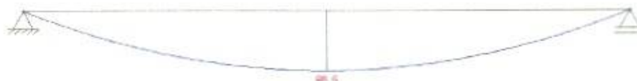
Figura 31 - Momento fletor máximo devido às cargas permanentes sobre a longarina Fonte: Os Autores.
