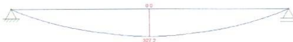
Figura 33 - Momento fletor máximo devido às cargas acidentais sobre a longarina Fonte: Os Autores.
